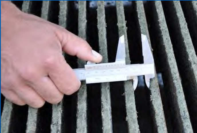
Spalte zwischen Rechen und Bauwerk
