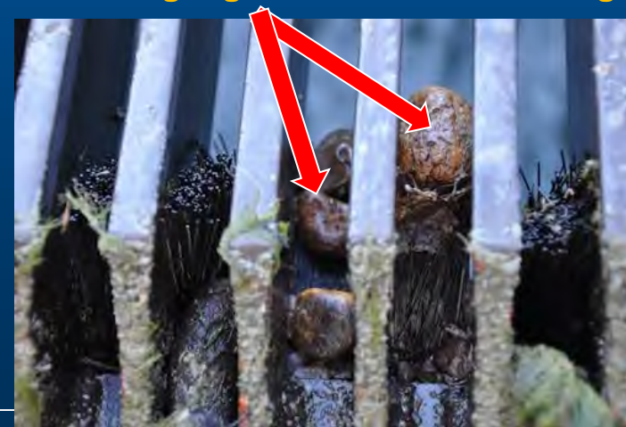
Beschädigungen der Borstendichtungen
